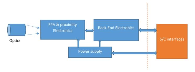
चित्र (1) विशिष्ट बेसलाइन नीतभार प्रणाली विन्यास Fig (1) Typical baseline payload system configuration
