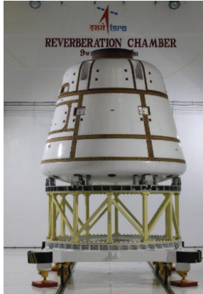
TV-D1 Ph-II Acoustic test
