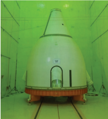
TV-D1 Ph-I Acoustic test
